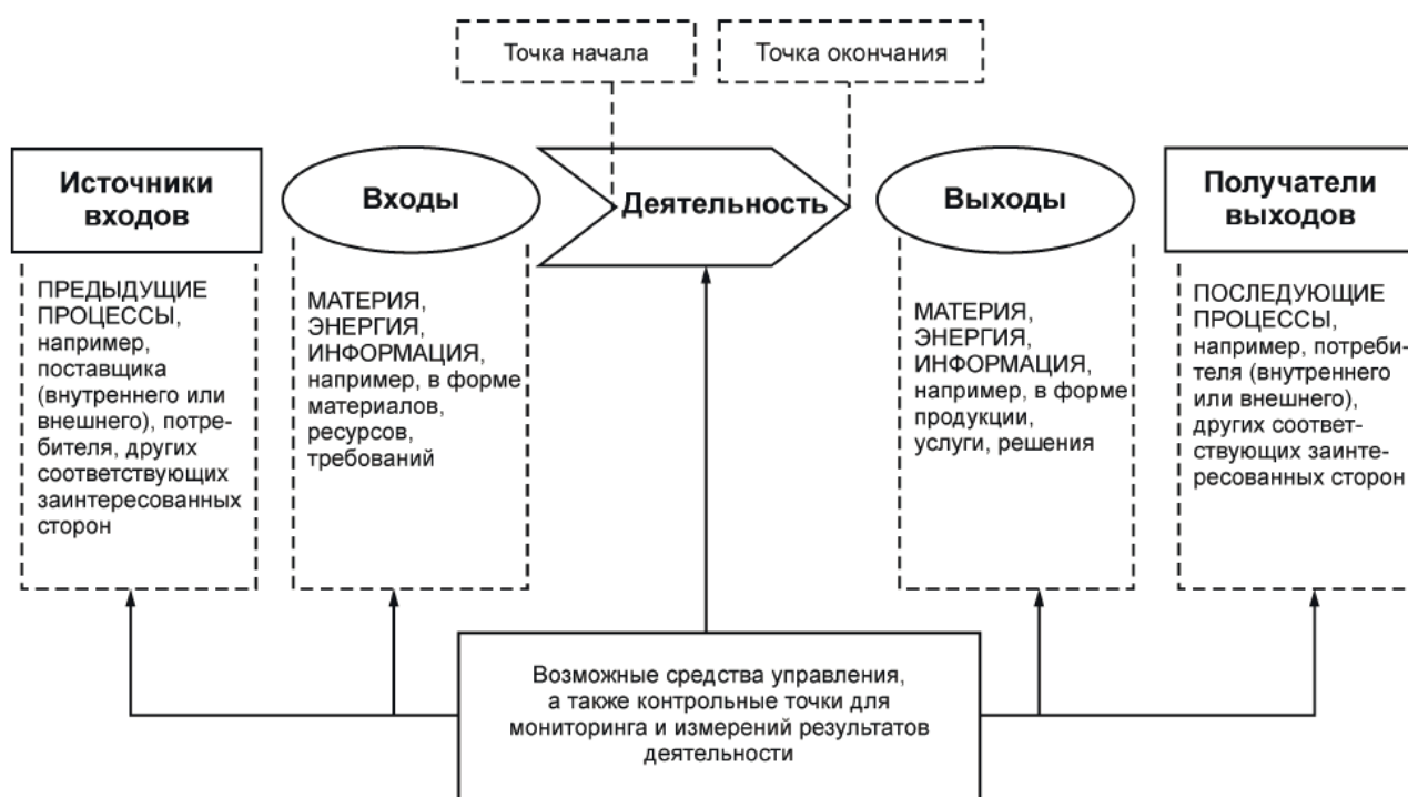
Рис.1 - Схематическое изображение элементов процесса
